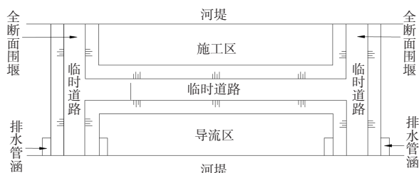
图 1 河道围堰及施工导流布置平面示意图
