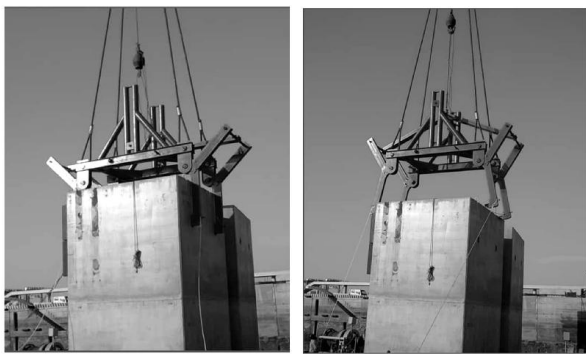
图6 吊钩开闭示意图
