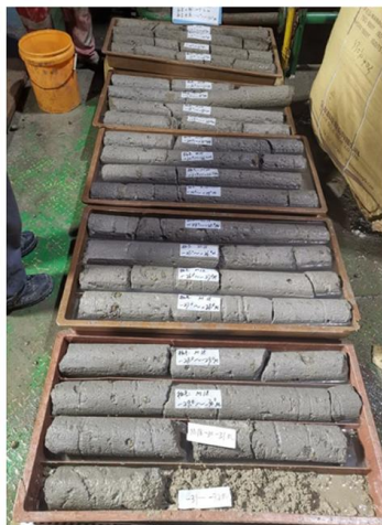
图 5 M18 现场取芯照片
