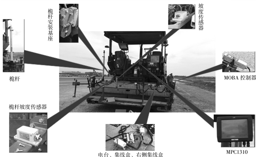
图 2 3D 摊铺机系统车载设备安装示意图
